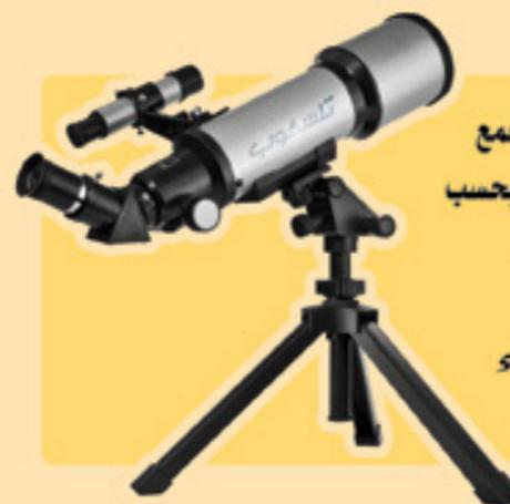
يسمى أيضا المقراب او الراصدة، وهو جهاز يستخدم لرؤية الأشياء البعيدة. يجمع الضوء مكونا صورة مقربة للأجسام البعيدة.. هناك عدة أنواع من التلسكوبات بحسب استخداماتها. فالتلسكوبات الأرضية، أما التي تستخدم لرؤية الأشياء البعيدة على سطح الأرض تسمى التلسكوبات الأرضية. أما التي تستخدم لرصد الأجرام السماوية كالنجوم والنجوم فتسمى التلسكوبات الفلكية. أما التي ترصد الأشعة المقبلية من الفضاء للأرض والتي لا تراها العين فتسمى التلسكوبات الراديوية.
